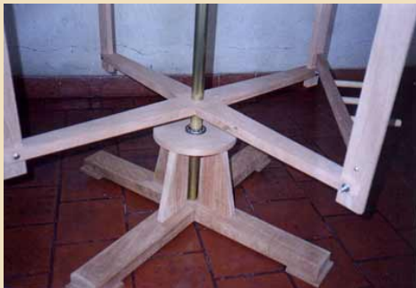
Urdidor giratorio de 1m de lado.
