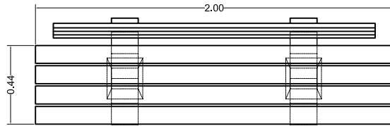
PLANTA DE BANCA REORDENAMIENTO URBANO DEL CERRO DE CHI IXIM, TACTIC, ALTA VERAPAZ
