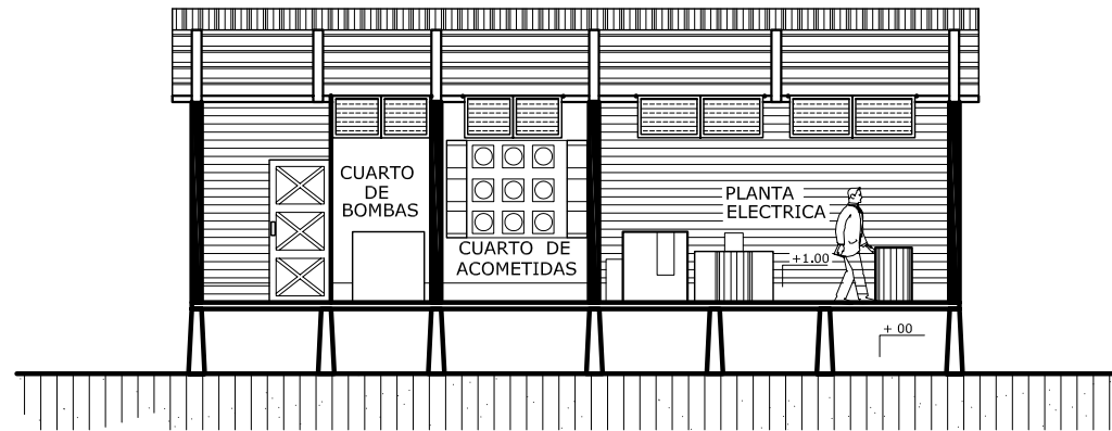
SECCIÓN DE CUARTO DE MÁQUINAS
