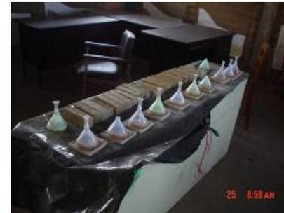
**Fotografía No. 42:** Colocación de embudos sobre cada probeta a ensayar
