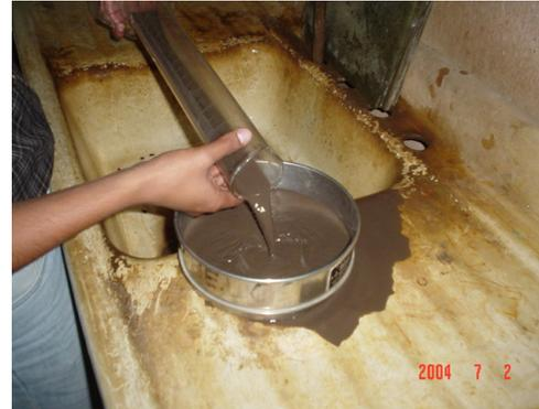
**Fotografía No. 32:** Vaciado luego de la última lectura de 24 horas sobre un tamiz 200
