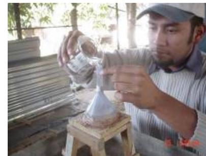
**Fotografía No. 44:** Ensayo en proceso, vaciado de agua sobre el embudo manteniendo constante el volumen de agua mientras la probeta absorbe
