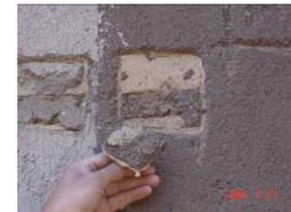
**ENSAYO DE ADHERENCIA POR ARRANCAMIENTO:** Es quizás el ensayo que más parámetros da para calificar los diferentes tipos de revestimientos y determinar cuál se adhiere mejor al muro de mampuestos de adobe. Sección de Materiales y Sistemas Constructivos del Centro de Investigaciones de Ingeniería, USAC.
