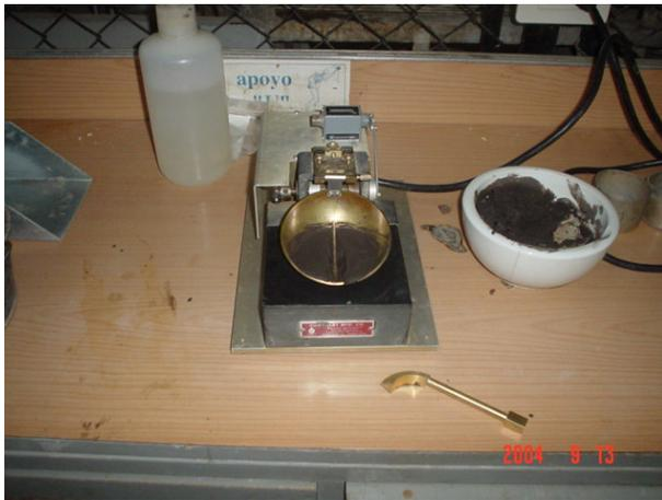
**Fotografía No. 34:** Equipo para realizar el ensayo de límites de Atterberg
