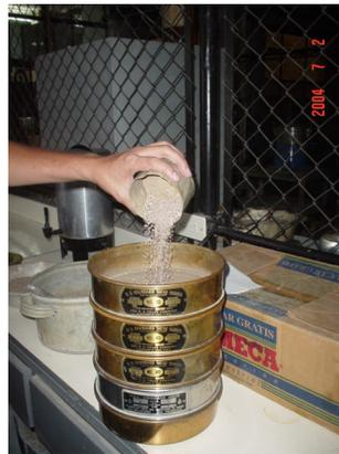
**Fotografía No. 33:** Vaciado del material seco para determinar porcentajes de finos
