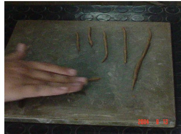
**Fotografía No. 35:** Realización del ensayo de límites de Atterberg para determinar la plasticidad del material
