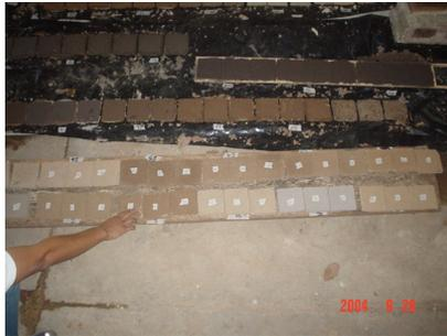
**Fotografía No. 41:** Elaboración de 3 probetas de 1\*10\*10 cm. De cada mezcla a ensayar
