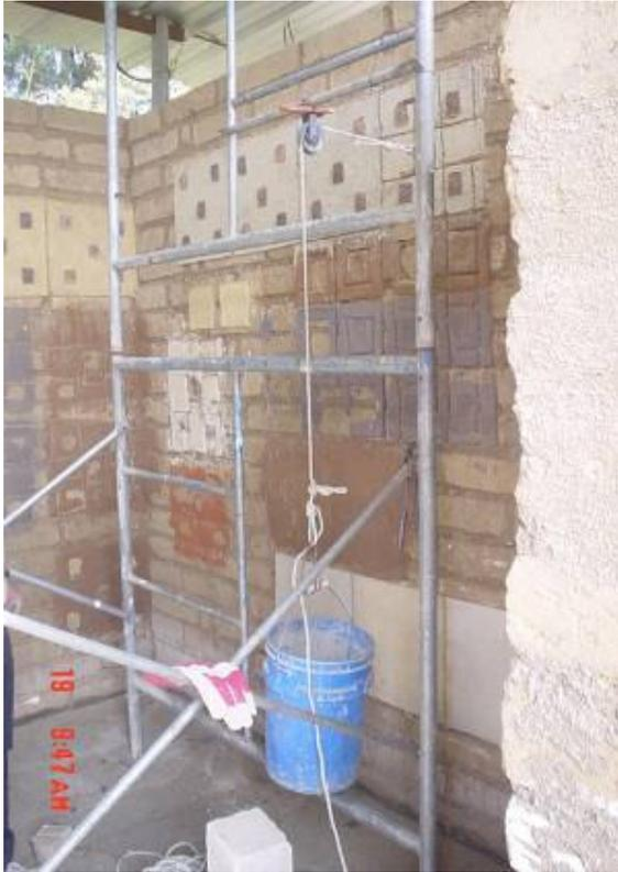
**Fotografía No. 45:** Equipo utilizado para la realización del ensayo de adherencia por arrancamiento
