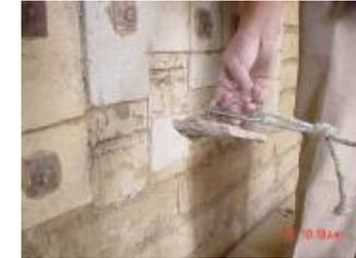
**Fotografía No. 48:** Aplicación de carga y desprendimiento de placa metálica
