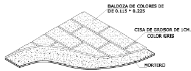
Detalle colocación de baldosa
