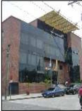
FOTO No. 01: EDIFICIO MUNIICIPAL, EN SU TIPOLOGIA CONSTRUCTIVA SE OBSERVA VOLUMENES DE DE LADRILLO DE BARRO COCIDO, Y DE ALUMINIO ANODIZADO + VIDRIO
