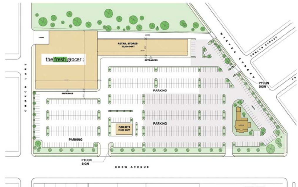
Imagen No. 10 - Diseño de Parqueo con Barreras Vegetales y Jardinería - Shopping Center USA
