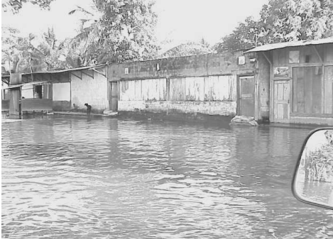
Fotografía No. 40 “Viviendas vulnerables a inundaciones debido a lo bajo de los niveles de sus pisos con respecto al agua desbordada”.
