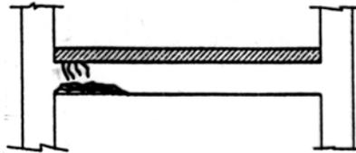
es decir, no están pandeados ni retorcidos. La aparición de este tipo de daños se debe a la formación de una articulación plástica. Si el núcleo de la viga está en buenas condiciones, y si en un piso dado este tipo de daño es menor al 25% entonces significa que es un buen diseño y que es usable pero requiere reparación.
