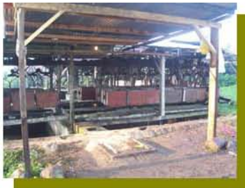
El funicular como sistema de transporte de café y como tecnología propia del beneficio. Elaboración propia Foto
