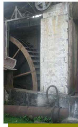
En esta foto se ve la rueda de agua que genera energía al beneficio, mide 4 mts. De radio y la corriente de agua pasa en la parte inferior y luego sigue hacia las caballerías. Elaboración propia Foto
