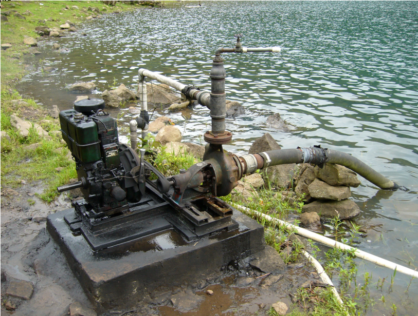
Foto No.3 Bomba de 3 hp. En la Laguna de Candelana en El Cráter Del Volcán de Monterrico, Agua Blanca, Jutiapa
