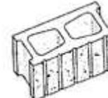
**Figura 18.** Superficie moldeada ranurada y pulida, 5 ranuras
