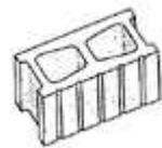
**Figura 10.** Superficie moldeada ranurada, 5 ranuras
