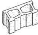
**Figura 5.** Superficie moldeada escalonada
