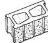
**Figura 21.** Superficie moldeada ranurada y partida, 3 ranuras
