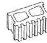
**Figura 13.** Superficie moldeada estriada, 5 estrias cortas
