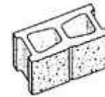
**Figura 20.** Superficie moldeada ranurada y partida, 1 ranura
