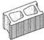
**Figura 4.** Superficie moldeada esgrafiada
