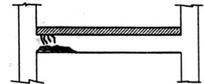
aparición de este tipo de daños se debe a la formación de una articulación plástica. Si el núcleo de la viga está en buenas condiciones, y si en un piso dado este tipo de daño es menor al 25%
