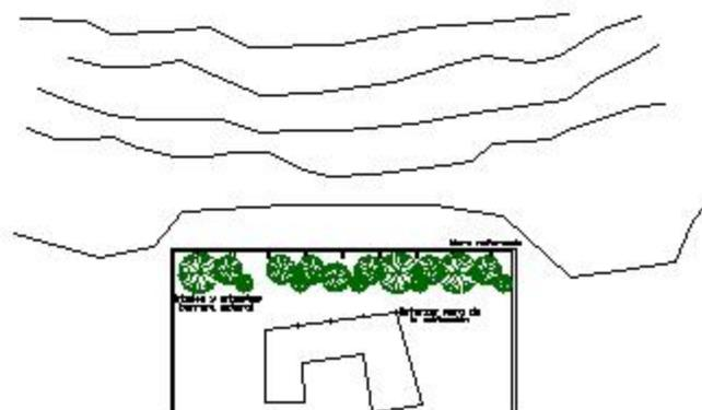
En terrenos inclinados ubicar la construcción al centro del lote y reforzar el muro perimetral en la parte crítica hacia la pendiente.
