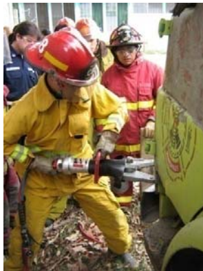
Foto No. 25 Extracción vehicular con equipo hidráulico (Quijada de la Vida), 2007. (Archivo de fotos del Sub-oficial Jhonnatan Rivas, 2007)
