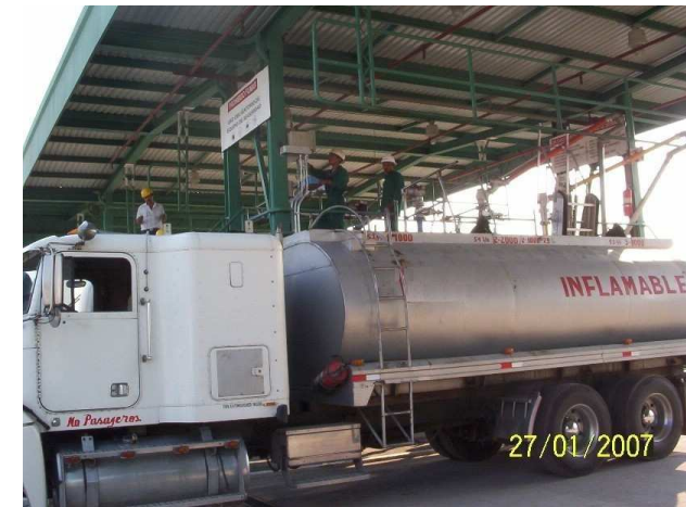
Fotografía No. 8, Despacho a camión tanque en rack de carga.
