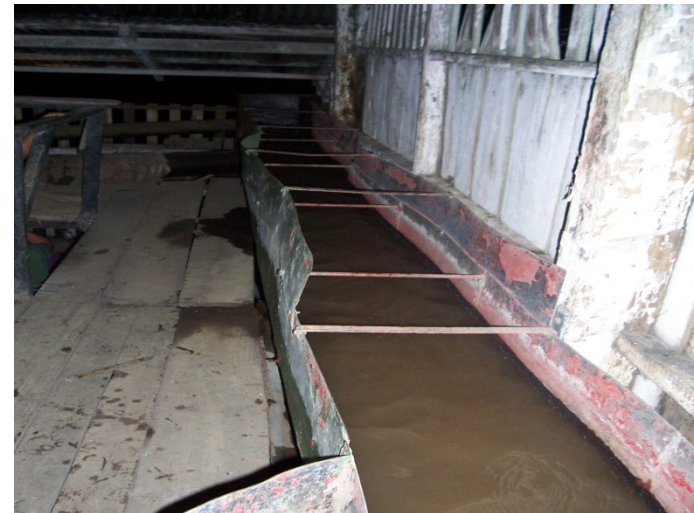
Foto # 12 Canales de corretaje del café Fotografía. W. de Paz y A. Pérez
