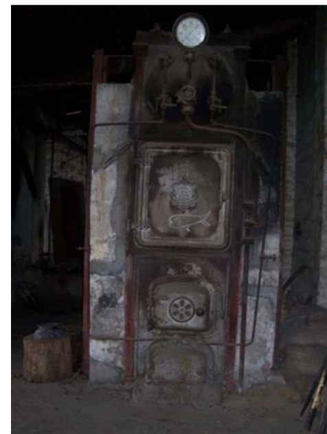
Foto #56. Calderas para secado de café beneficio seco. Fotografía: W. de Paz y A. Pérez
