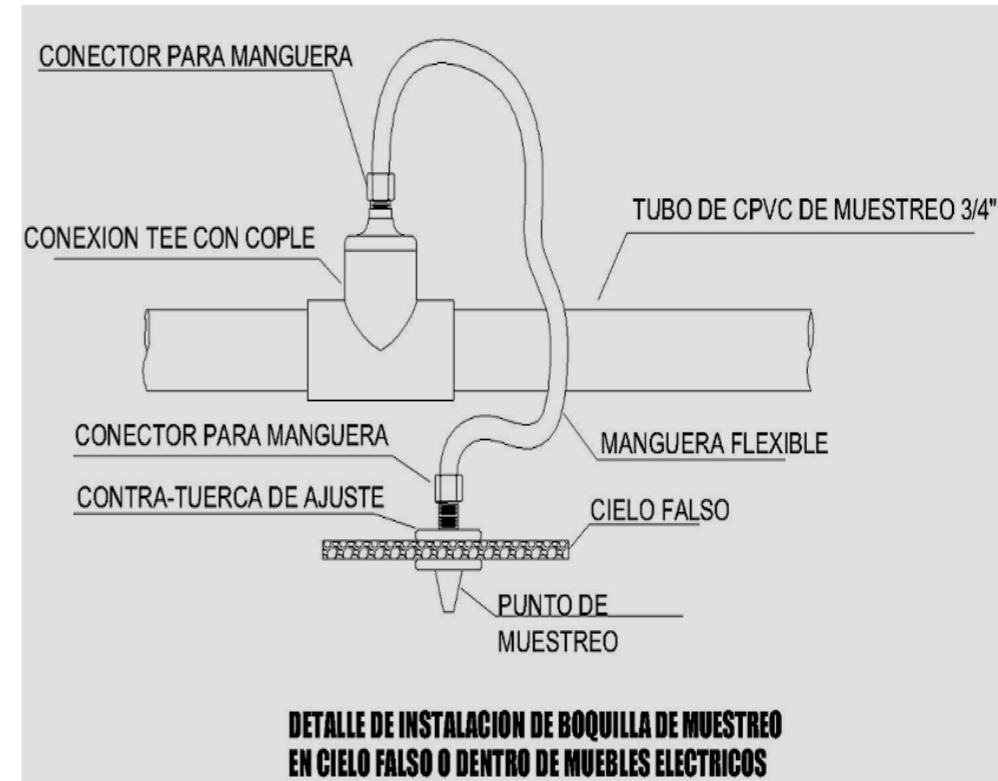
Figura No 31 Detalles de instalación de tubería colgada en losa o estructura en los sistemas de detección de humo por aspiración de aire
