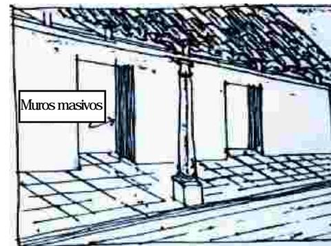
La arquitectura se ve influenciada por la situación sísmica utilizando muros m a s i v o s proporcionados.
