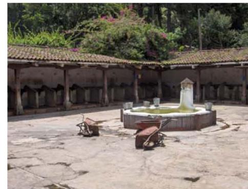
Foto del interior de la lechería en donde se observa el uso de columnas con pilares y capiteles de madera, base de piedra, cubiertas inclinadas con estructura de madera y teja de barro.
