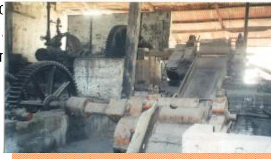
Sus instalaciones albergan una maquinaria Krupp de 1869, movida por vapor, usando doble trapiche y hornos metálicos con chimeneas incorporados y caldera.
