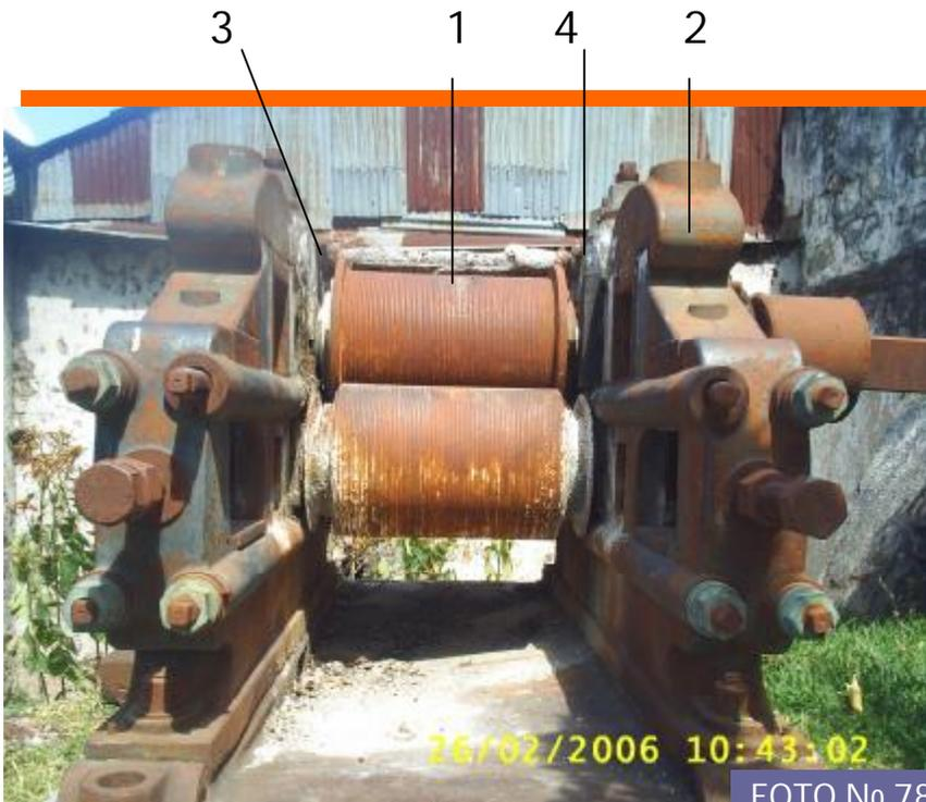
Imagen lateral de la doble Virgen del Trapeiche. En él se observan los deterioros y corrosión del metal. Año 2006, foto propia
