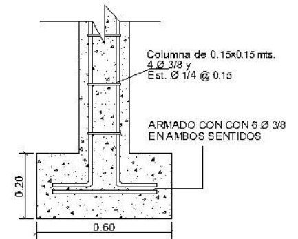
Sección de Zapata
