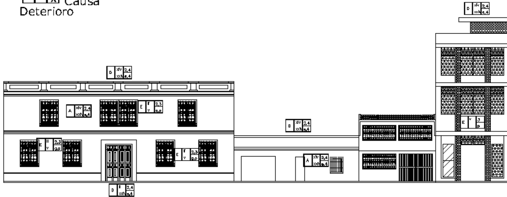
ELEVACIÓN DEL SEGUNDO TRAMO CUADRA NORTE, Analisis de Deterioro y Alteraciones
