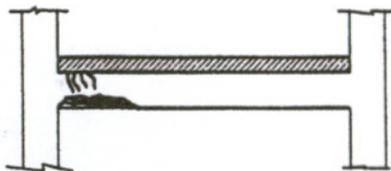
aparición de este tipo de daños se debe a la formación de una articulación plástica. Si el núcleo de la viga está en buenas condiciones, y si en un piso dado este tipo de daño es menor al 25% entonces significa que es un buen diseño y que es usable pero requiere reparación.
