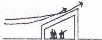
UTILIZAR LA FORMA DEL TECHO PARA REDUCIR AL MÍNIMO LA PRESIÓN LEVANTADORA DEL VIENTO
