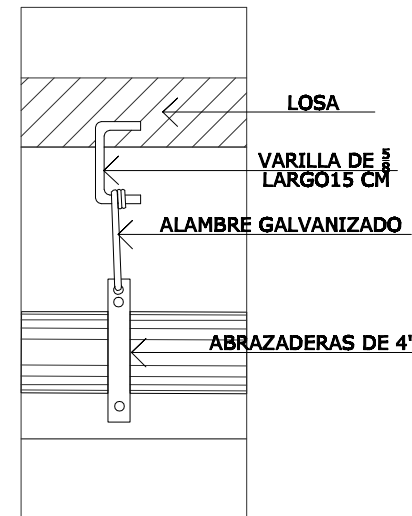
DETALLE COLOCACION DE TUBERIA SUSPENDIDA EN CIELO
