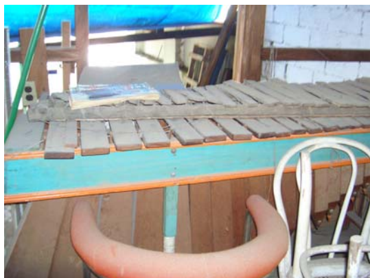
Fotografía No. 25. Fabricación de teclas para una marimba grande. Fuente: Elaboración propia.
