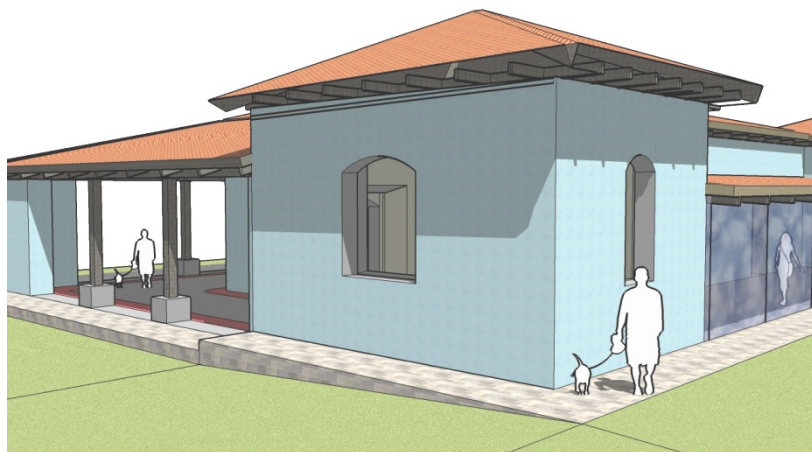
Reintegración del techo de teja, en la fachada noroeste
