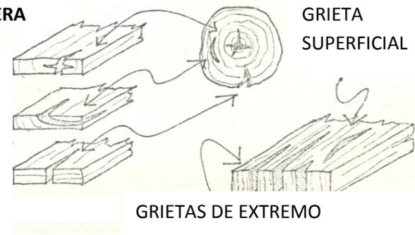
FIGURA No. 10. ZONAS CRÍTICAS PARA GRIETAS EN PIEZAS A FLEXION, SIMPLEMENTE APOYADA.
