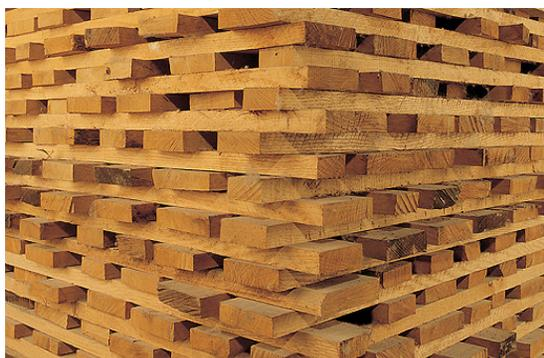
FIGURA No. 16 Madera en proceso de secado natural.
