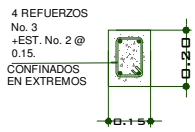
SECCION VIGA TIPO 3 V-3 ESCALA 1:25
