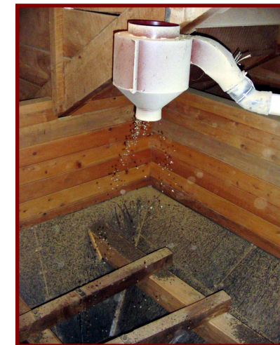
LIMPIEZA DEL GRANO EN PERGAMINO Fotografía propia No 37, ubicada dentro del beneficio. ref. No.2 en gráfico No.5
