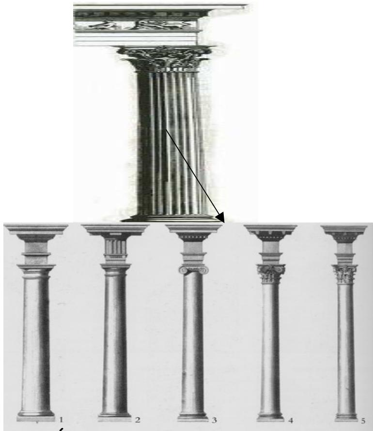
FOTOGRAFÍA No 27: Divisiones de una columna Una columna, independientemente de su procedencia en tiempo y lugar, está dividida en basa, fuste y capitel. En este ejemplo el fuste está estriado y el capitel es corintio.
