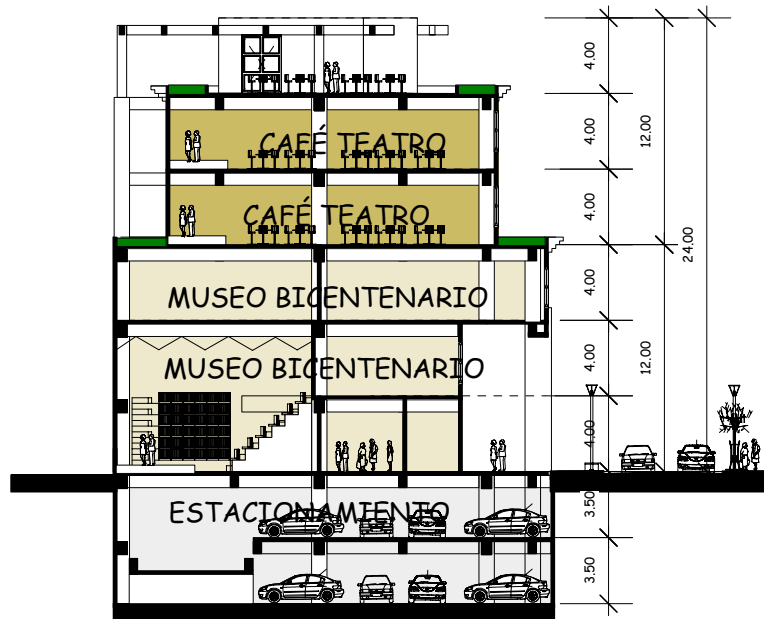
Sección longitudinal A-A Centro Cultural del BICENTENARIO
