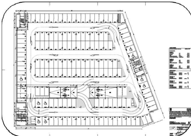
En el plano se observa la planta del sótano uno en el cual se aprecia la modulación de las columnas y cada uno de los espacio de aparcamiento, así como la circulación que se propone para los vehículos que hagan uso del mismo, además se observa que se tiene previsto
