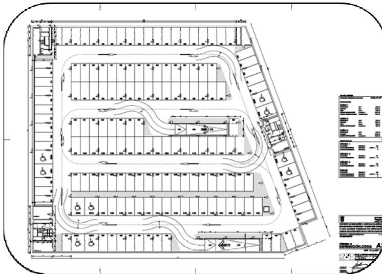
En el sótano podemos observar que se tiene la misma modulación estructural que el sótano uno, la cantidad de aparcamientos es casi la misma, por que se concluye que es una planta tipita, con la única diferencia en la ubicación de las rampas vehiculares, las cuales están ubicadas en lugares distintos, el
