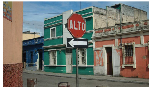
Fotografía 4: Señalización; Altos. Los encontramos en la mayoría de las esquinas, dando el alto a los vehículos que circulan sobre las calles su material es de lámina galvanizada, pintura reflectiva y poste de aluminio redondo, Autor: Manuel Soto, Octubre 2008.
