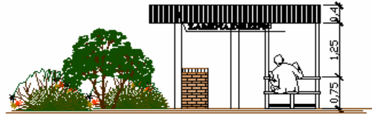
ELEVACIÓN 1 DE MESAS TECHADAS ESC.: 1/100
