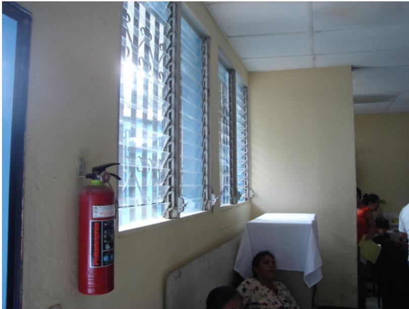
**FOTOGRAFÍA NO. 15** Esta imagen muestra uno de los extinguidores usados en el Centro de Salud, estos son requeridos por el M.S.P.A.S. ya que en algunos lugares como el laboratorio, se trabaja con sustancias inflamables, y además, es una edificación pública, por lo que la seguridad de las personas debe ser tomada muy en serio.
