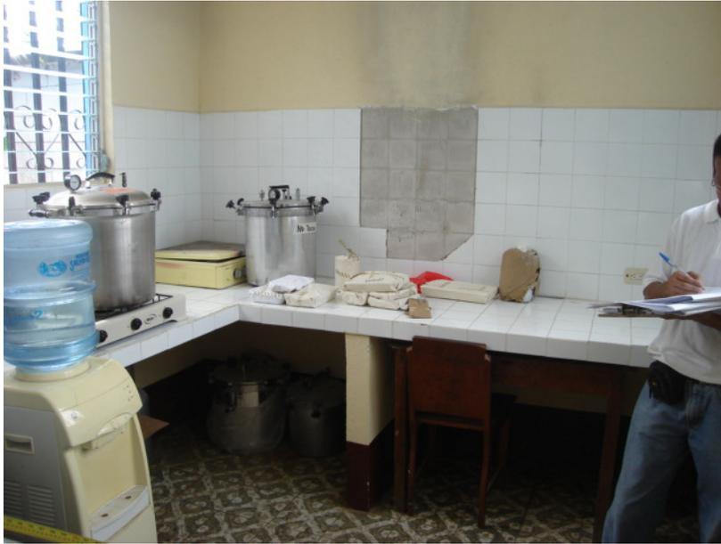
**FOTOGRAFÍA NO. 17** Esta imagen muestra la habitación de la Central de Esterilización y Equipos (C.E.Y.E.), no cuentan con una autoclave, sino que únicamente cuentan con ollas de presión industriales, estas sirven para esterilizar, aunque una autoclave es mejor, además usan azulejos, lo cual hace fácil la limpieza, pero se puede acumular suciedad en las cizas, por lo que es mas aconsejable una habitación con un acabado alisado y pintura epóxica.
