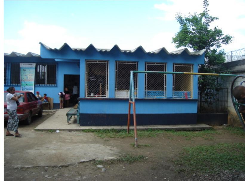
**FOTOGRAFÍA NO. 10** Esta imagen muestra la fachada frontal del área de vectores del Centro de Salud, la cual tiene techo de lámina canaleta y las ventanas únicamente tienen una malla metálica y no vidrio, el área de vectores es un área muy importante en las poblaciones con clima cálido y húmedo, ya que se encargan del control de plagas en la comunidad.
