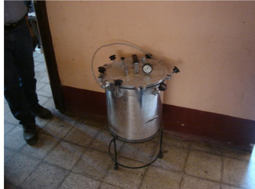
**FOTOGRAFÍA NO. 30:** Esta imagen muestra la autoclave de mesada que se usa en este Centro de Salud para la esterilización en la C.E.Y.E. ya que no cuenta con una autoclave típica.
