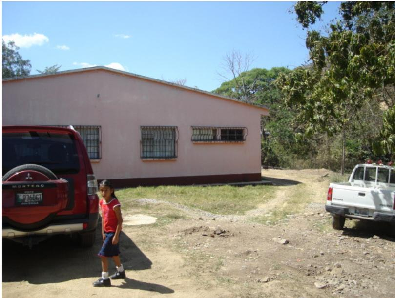
**FOTOGRAFÍA NO. 25:** Esta imagen muestra el edificio de la consulta externa, es el mismo sistema constructivo, además de ser un edificio bastante alto, con 4.96 m. en el punto más alto, y 3.60 m. en los puntos más bajos del techo a 2 aguas. Existe un área bastante grande donde se podría hacer una ampliación u otro módulo.
