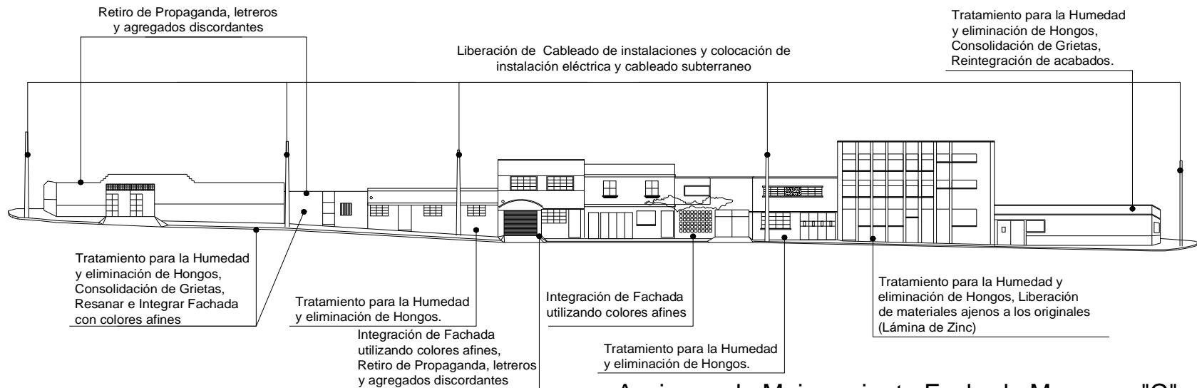
Acciones de Mejoramiento Fachada Manzana "C"
