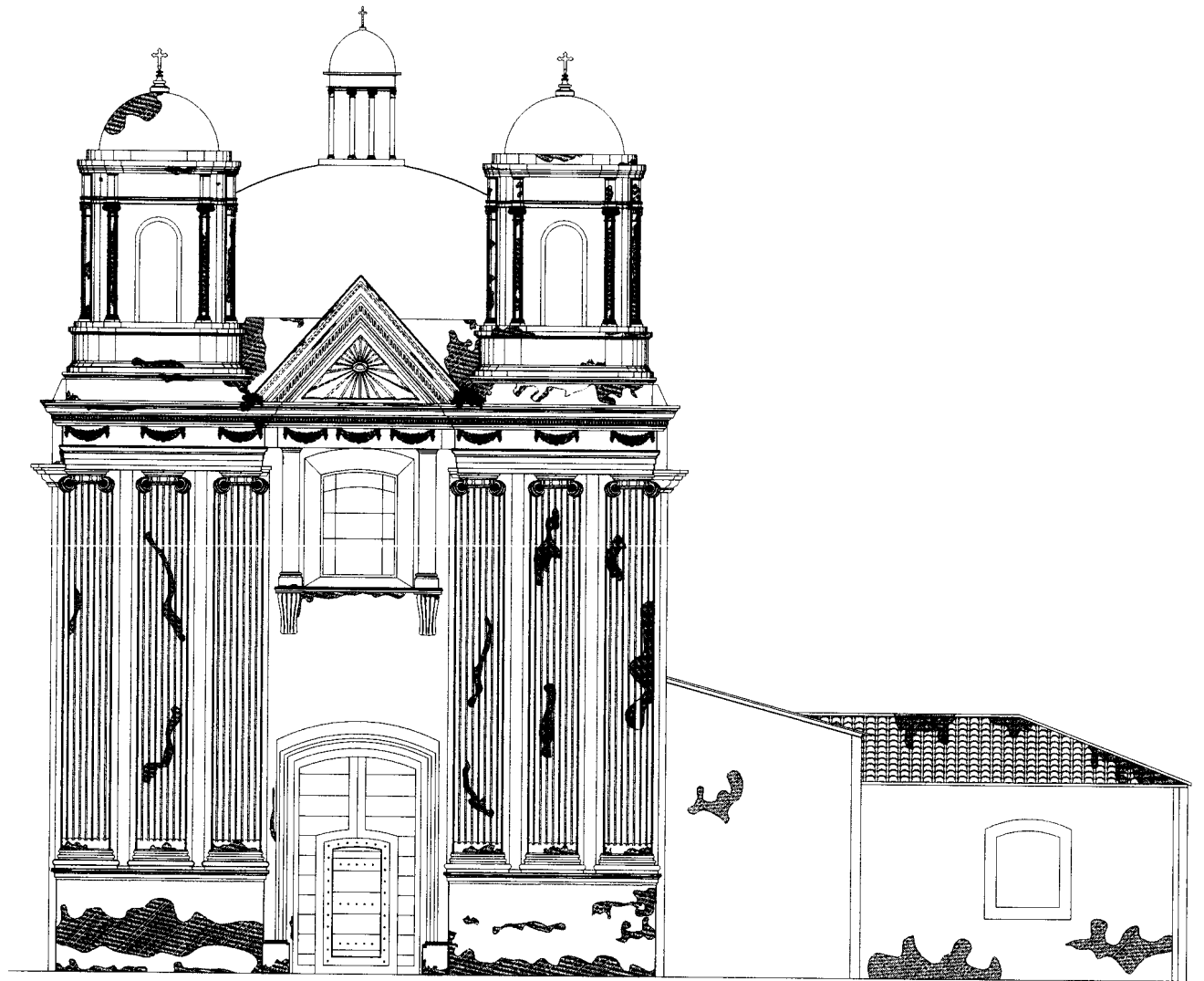
Fachada Frontal. Situación Actual
