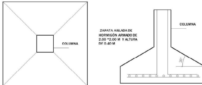
ILUSTRACIÓN No. 53 ZAPATAS DE HORMIGÓN ARMADO
