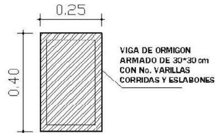
ILUSTRACIÓN No. 55 ÁREA DE VIGA DE HORMIGÓN ARMADO
