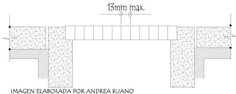
Separación máxima entre rejillas y coladeras de 13mm.
