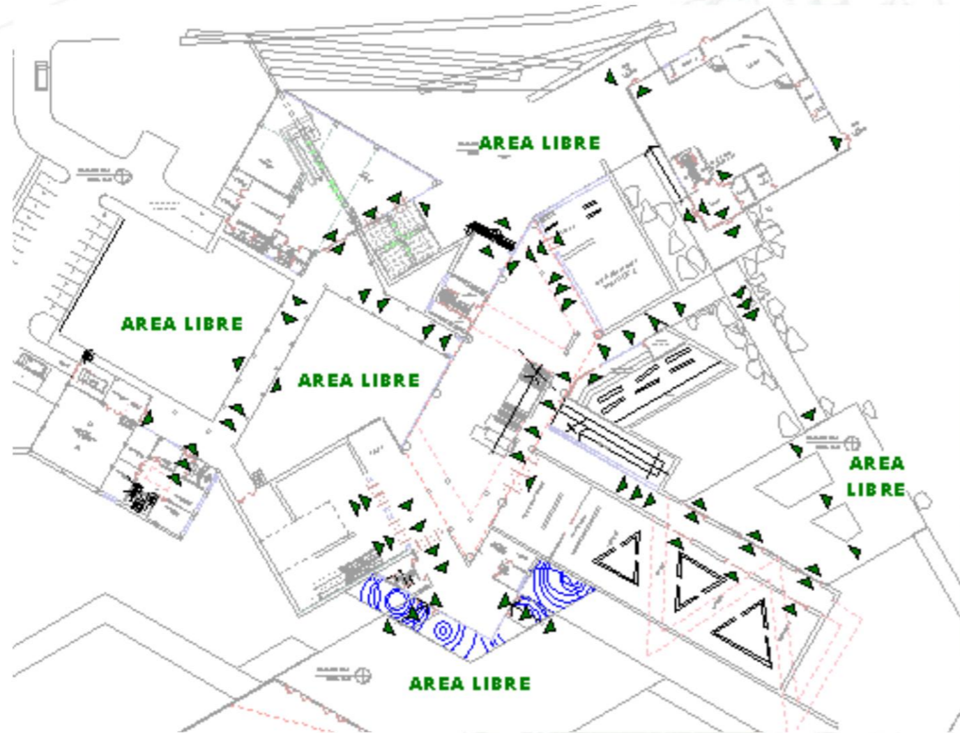
ruta de evacuacion
