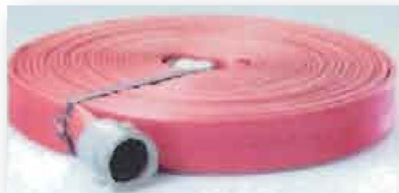
Fabricada con tubo interior ultraligero de nitrilo sintético, una capa de fibra tejida 100% poliéster y una capa de nitrilo extruido.
