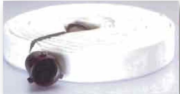
Fabricada con tubo interior de poliuretano permanentemente adherido de fábrica a la fibra y una cubierta simple de filamentos de poliéster de gran resistencia. Sus características son: 100% sintética, sumamente liviana, flexible y compacta, no requiere mantenimiento, resistencia al moho.
