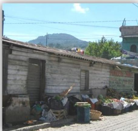
FOTO 16, Fuente: elaboración propia. Construcción de adobe a media altura y madera con techo a dos aguas con estructura de madera y duralita.
