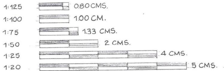
La siguiente figura muestra la representación gráfica de un cubo de 1Mt. de ancho x 1Mt. de alto x 1Mt. de profundidad, en diferente escala.
