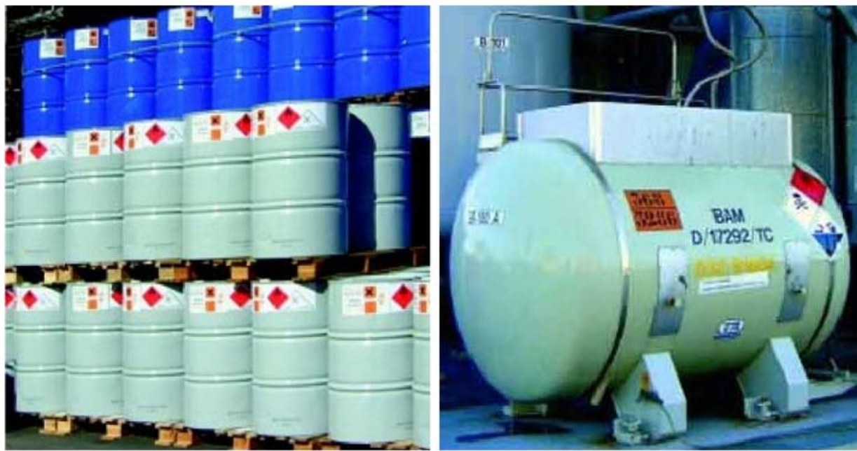
Gráfica 7.33 Señalización Industrial, Identificación de tanques y recipientes, 7.33A Recipientes y 7.33B Tanques de almacenamiento. Fuente: Imágenes Google, Señalización de tanques de almacenamiento.
