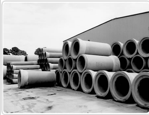
Tuberías de concreto
