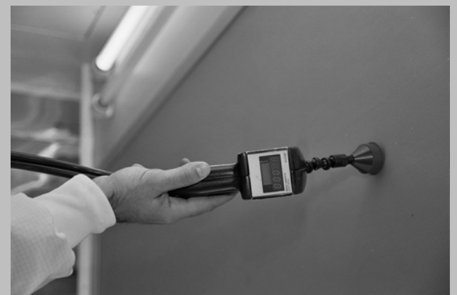
Gráfica 4.52 Arriba, Test de calidad de filtros HEPA; Abajo, Test Conteo de Partículas, Proceso de Cualificación de la Instalación Fuente: Validación farmacéutica: consideraciones básicas, Encarnación García Montoya
