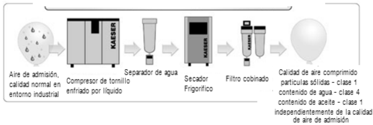
Gráfica 5.107 Sistema certificado de tratamiento de aire, opción eficiente a la compra de compresor exento de aceite. Fuente: Documento, Producción eficiente y confiable de aire comprimido de excelente calidad, Compresores Kaeser, www.mx.kaeser.com
