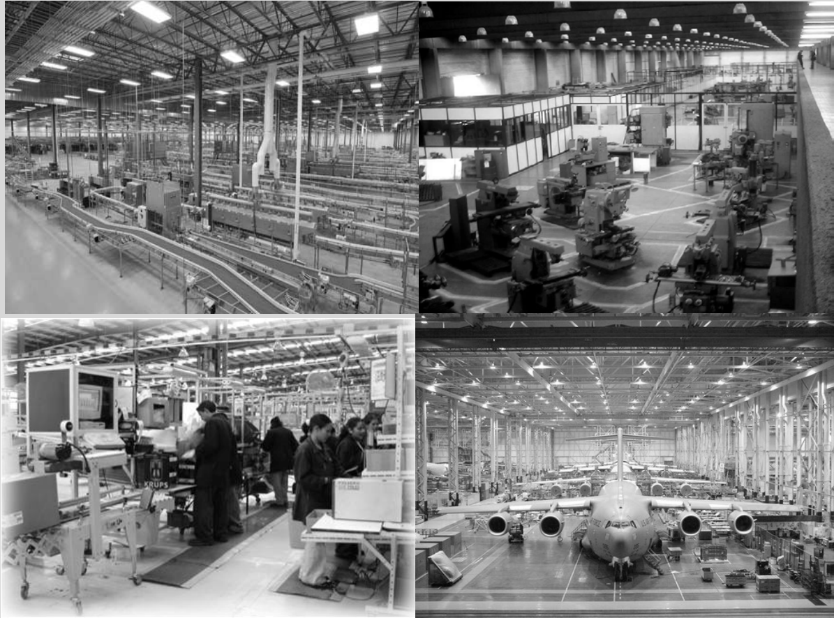
Arriba, Izquierda; Proceso en Línea (Envasado de Bebidas), Derecha; Producción Por Proceso (Talleres-Fabrica Piezas de Autos), Abajo, Izquierda; Proceso Por Grupos (Ensamble de Electrodomésticos), Derecha Producción Por Posición Fija (Ensamble de Aviones)
