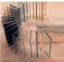
**Vidrio Laminado o laminar:** es el formado por dos o más láminas (lunas) unidas entre sí por una lámina de material plástico (butiral de polivinilo PVB). Si se llega a romper, no se producen desprendimientos, una de sus mayores cualidades es la resistencia a la penetración, por lo cual está considerado como un vidrio **de seguridad**. También nos ofrece buenas cualidades ópticas, protección a los rayos ultravioleta y protección acústica. Pueden clasificarse en:
