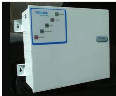
Se generan impulsos eléctricos de alto voltaje en la valla, por tanto hay que conseguir pulsos de corta duración, es decir de alta frecuencia y con ellos atacar la base de un transistor que activará el primario del transformador y así obtener los pulsos de alto voltaje en el secundario.
