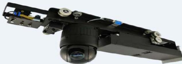
*El sistema SmartTrack, se controla mediante una consola con joystick convencional, de forma inalámbrica mediante una PDA o PC portátil o a través de internet, desde cualquier parte del mundo.*
