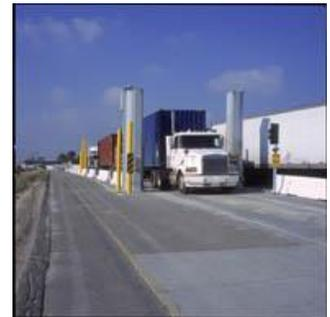
Este sistema es utilizado en países industrializados y recientemente en Puerto Santo Tomás de Guatemala. El sistema hace un escaneo permanente de los vehículos que ingresan por intermedio de tecnología de radios gamma, con lo cual se puede apreciar una radiografía del 100% del vehículo. Un operador suficientemente capacitado es suficiente para garantizar la máxima efectividad y lo mejor es que eventualmente puede hacerse supervisión por la memoria que genera el equipo.
