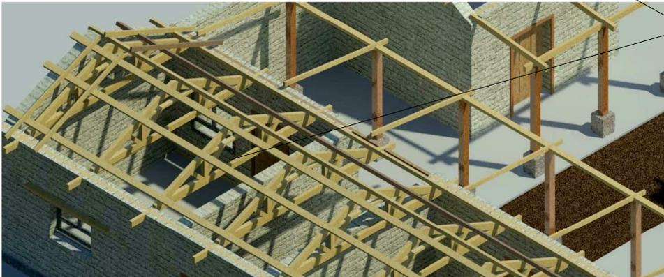
Se observan los elementos estructurales que forman y dan soporte a la cubierta la cual originalmente estaba constituida por tejas de barro, pero por el daño sufrido en el terremoto de 1976, se cambio por lámina
