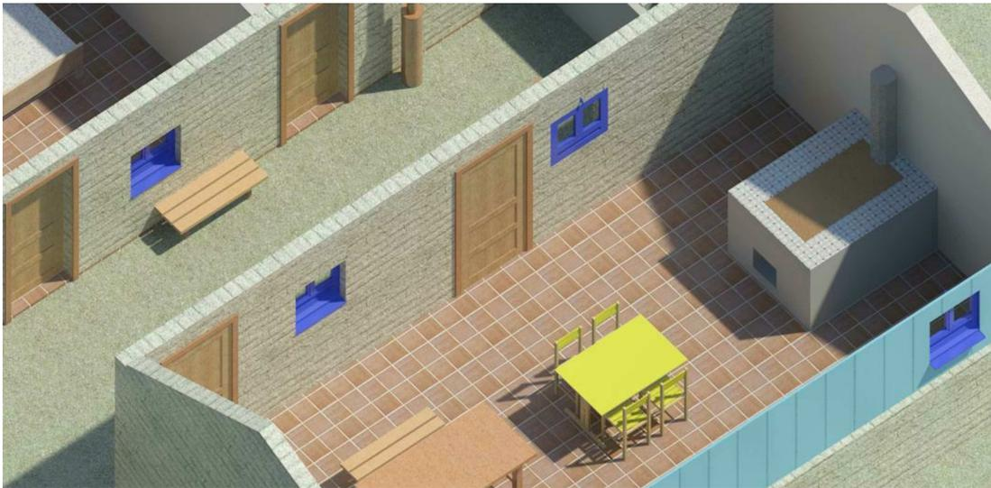
En esta vista se pueden observar elementos como lo son la conformación de piso el cual es ta integrado por baldosas de barro cocido, los materiales utilizados para el poyo constan de adobe con una plancha de barro, a sus costados dispuestos unidades de cerámica decorada, el mobiliario esta básicamente conformado por muebles de madera como lo son el pino y cedro.
