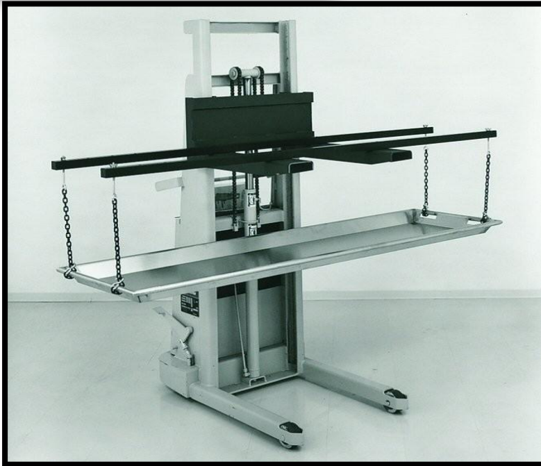
Ilustración 16: Elevador de cadáveres, el cual proporciona mayor comodidad al momento de cargar o descargar los cadáveres en sus respectivas cámaras frigoríficas.
