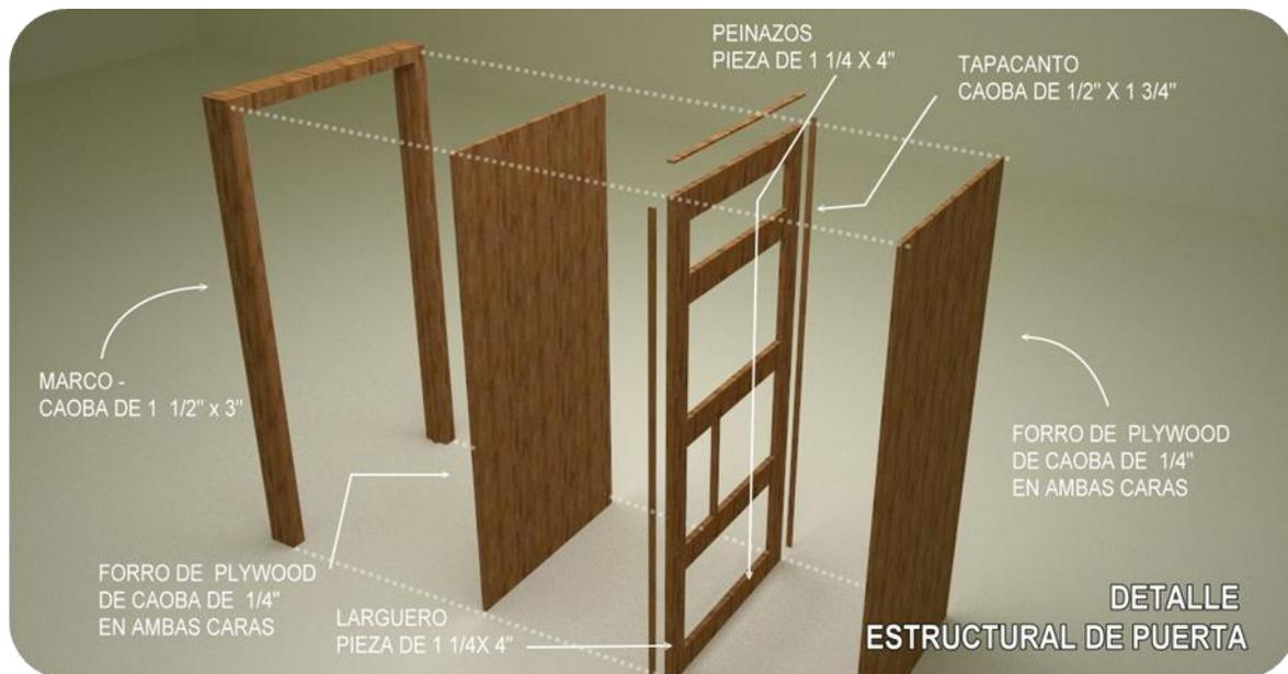
Figura 28: Conformación de Puerta
