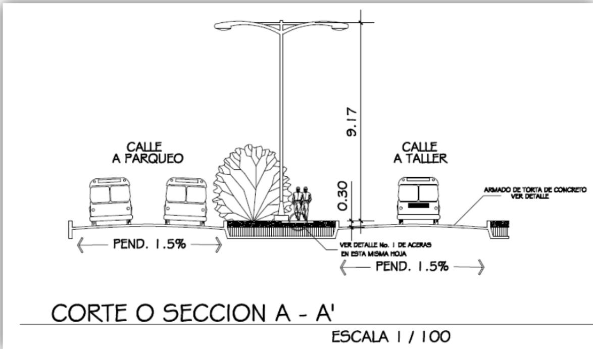
Figura 29: Diseño de Gabaritos
