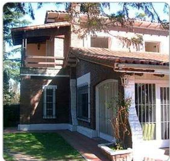
Muros, los muros exteriores son de ladrillo visto mientras que en el interior cuenta con cernido y repello.
